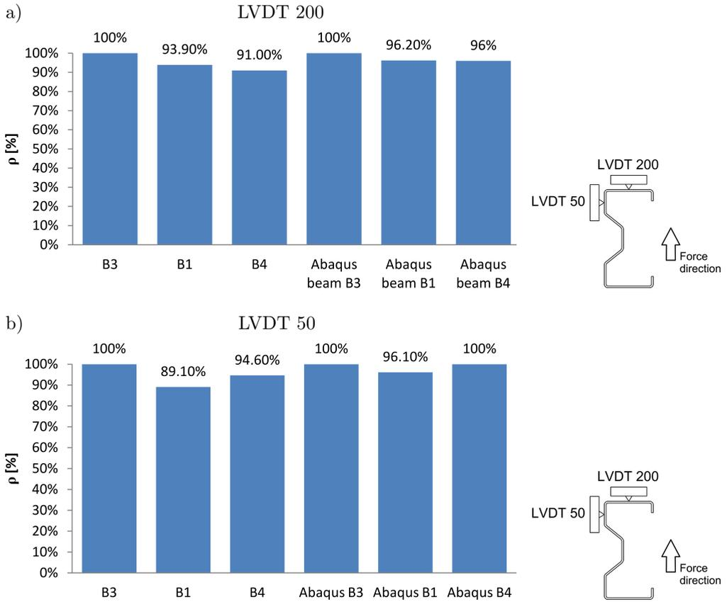
FIG. 6. Displacement reduction parameter  $\rho_i$ : a) vertical displacement LVDT 200, b) horizontal displacement LVDT 50.
