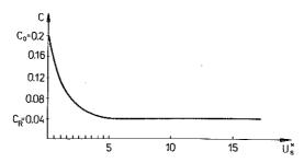
Fig. 6. The material cohesion parameter c.
